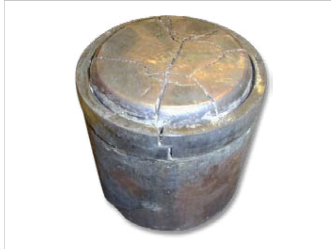
Pistone dopo 165342 iniezioni Plunger after 165342 injection
