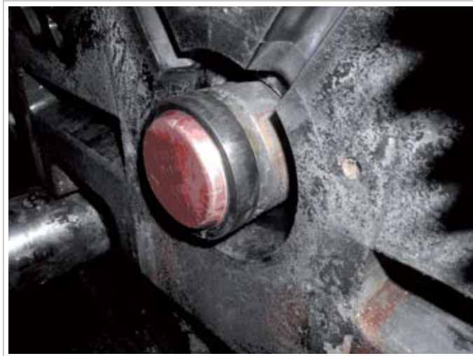
Pistone dopo 87000 iniezioni Plunger in operation at 87000 shots
